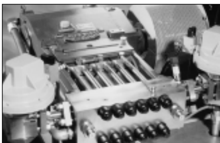
Obr. 2 Konštrukcia mobilného tlakového agregátu URACA typ RS 716D /2800 bar.
