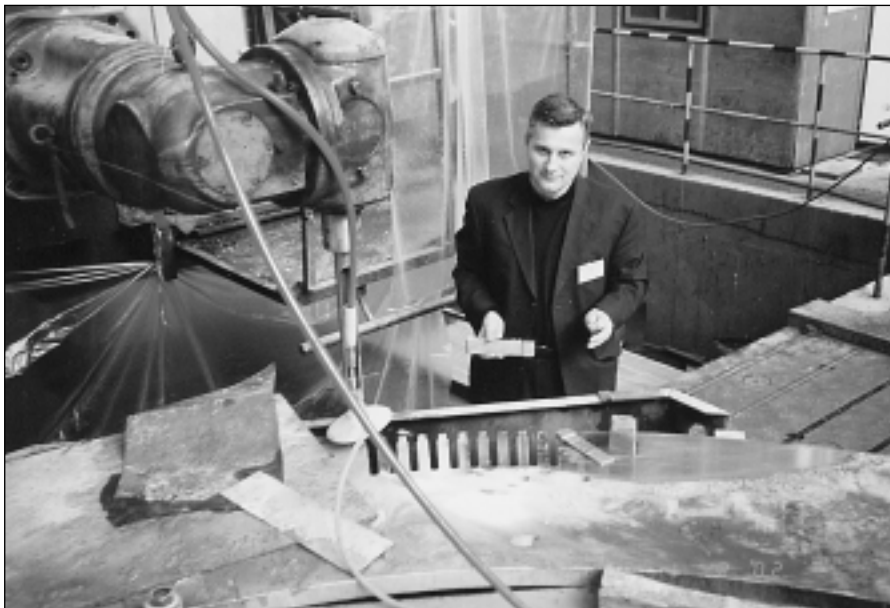
Obr. 3: Praktické využitie agregátu URACA 2800 bar na rezanie abrazívnym vodným lúčom nerezovej ocele hr. 60 mm s abrazívnou rezacou hlavicoú.
